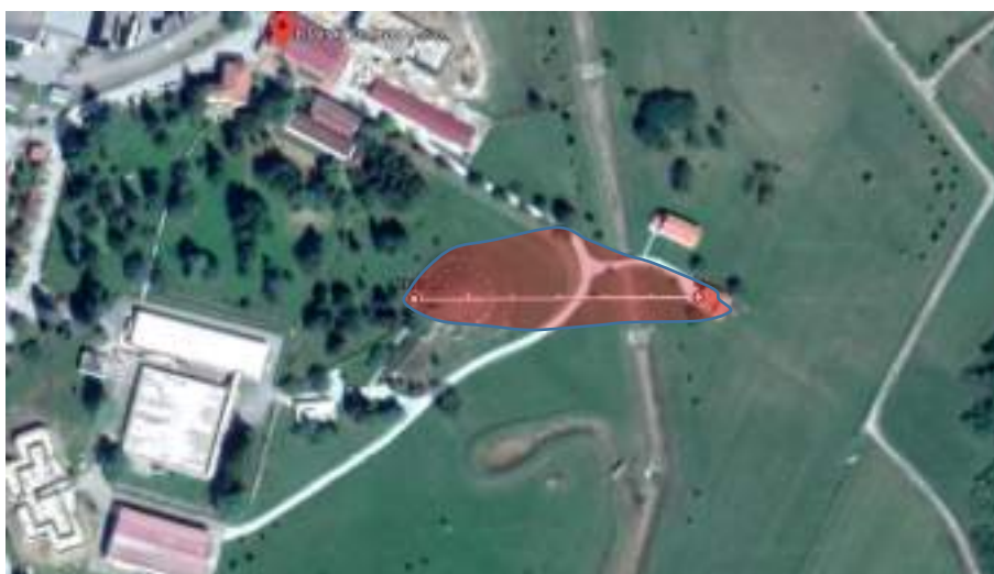
Slika 24: Radijus kretanja oblaka klora u pogonu Sv. Ivan Izvor podataka: Procjena ugroženosti Grada Buzeta
